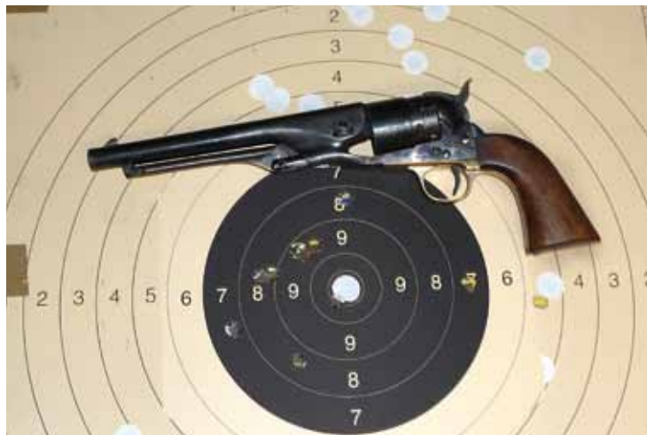
Schießtest 1. Mit dem Centaure-Thuer ergab sich bei Haltepunkt Fleck auf 25 m obiges Schussbild. Verschossen wurde ein 200-gr-BB-Geschoss.
