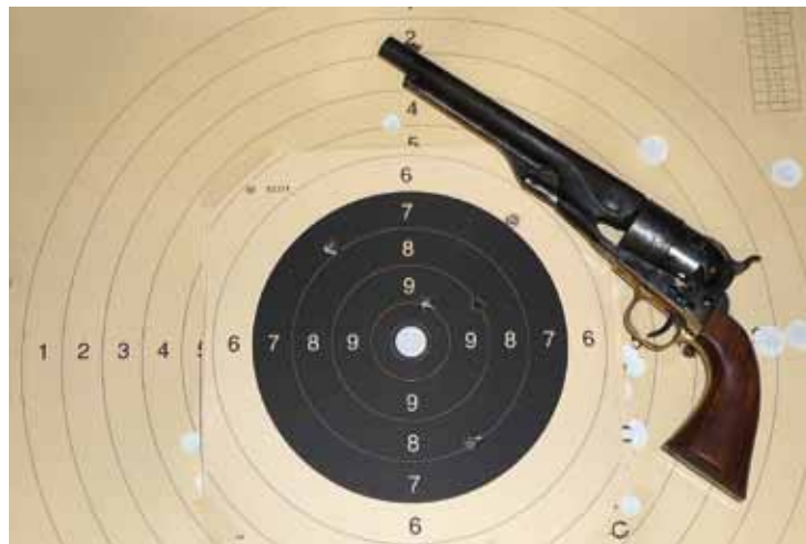
Schießtest 2. Dieses Schussbild wurde mit dem abgebildeten Uberti-Thuer geschossen, Schussdistanz 25 m, stehend freihändig, Haltepunkt Fleck.
