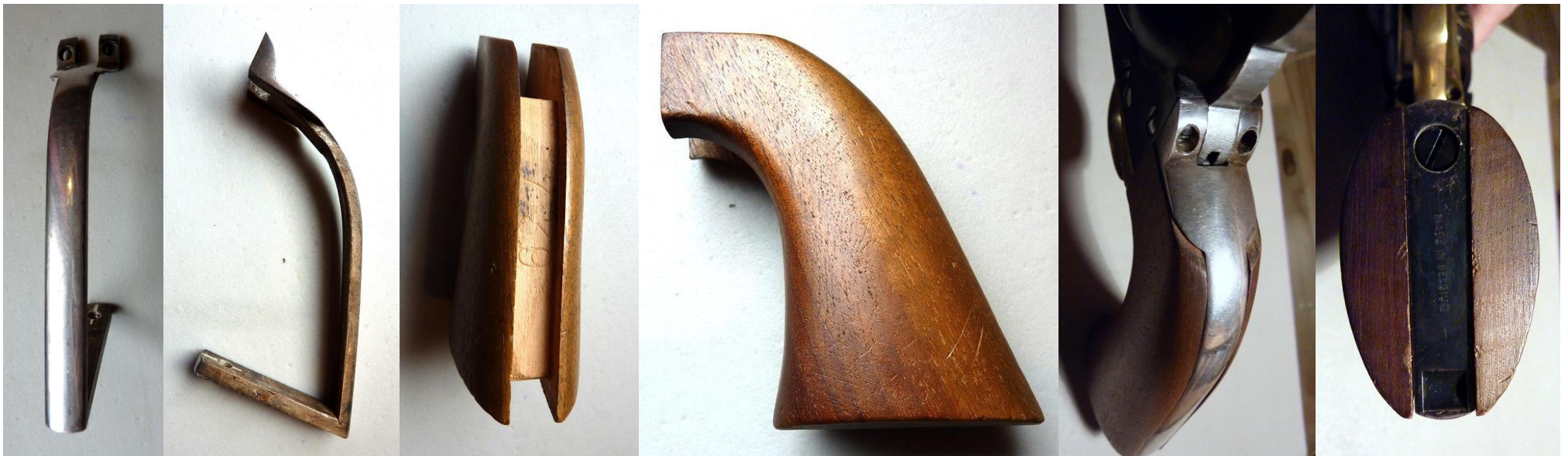
Frankenstein RNMA grip: Backstrap silver plated w/o serial number; digits of serial number 739 stamped in wood in Centaure manner; badly fitted wood to backstrap and buttstrap | Frankenstein-RNMA-Griff: versilberter Griffücken ohne S/N; S/N-Ziffern 739 in Centaure-Manier ins Holz gestempelt; schlechte Passungen vom Holzgriff zu Abzugsbügel und Griffrahmen
