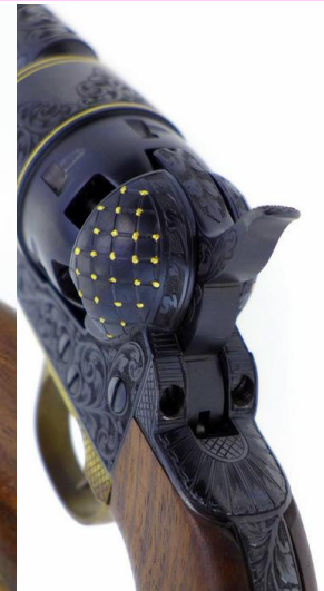
RNMA #7714 (von links): Goldeinlagen, -punkte auf graviertem Trommel und Rahmen
