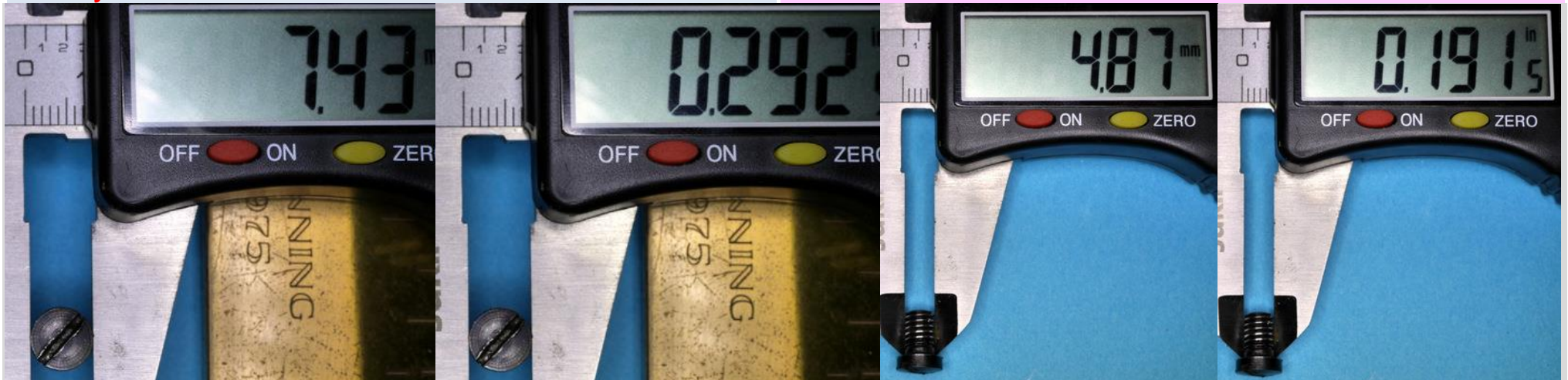
From left comparative views of 1 st or small version butt screws: measurements of RNMA #6274 are shown first in millimeter then in inch/Von links vergleichende Ansichten der Griffbodenschrauben 1. bzw. kleine Version: spezifische Messungen an RNMA #6274 erst in Millimeter, dann in Inch
