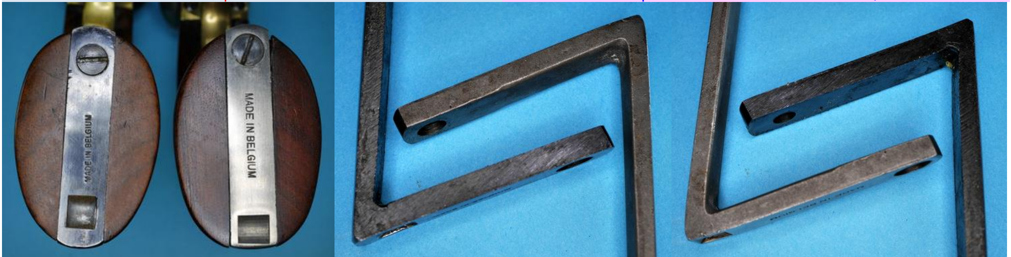
Comparative views from RNMA back straps #6374 and #13859 from left: 1 st or early "welded" version vs 2 nd or late "cast" version; cast over welded back strap; welded over cast back strap/Vergleichende Ansichten der RNMA-Griffrückten von #6374 und #13859: 1. oder frühe "geschweißte" vs. 2. oder späte "gegossene" Version; gegossene Version oben, geschweißte unten; geschweißte Version oben, gegossene unten
