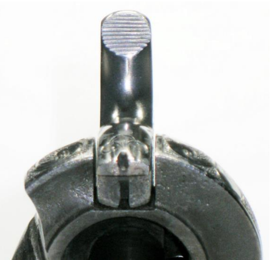
Von links: übliche Kreuzriffelung des Hammersporn vs. gerade Riffelung von #13988
