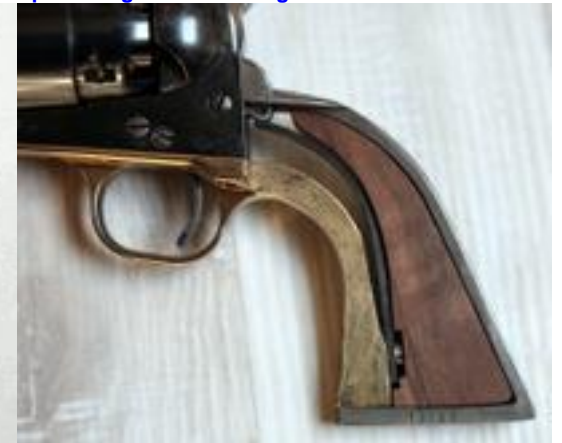
Von links: der leicht verdrehter Front-Strap war eine Herausforderung; die 3 Holzteile des grob gesägten und konturierten Griffs werden zusammengeleimt
